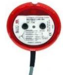
**Kompakt-Leckagesensor; konduktiv** ; ohne Auswerteeinheit arbeitend mit integriertem Messumformer; zur Montage in Auffangwannen- und räumen gemäß Wasserhaushaltsgesetz; für Anlagen zum Lagern, und Umschlagen wassergefährdender, nicht brennbarer Medien; Sensorhöhe 1mm; Schutzart IP67; Spannungsversorgung 15...27V DC; Ausgang: potentialfreier Reedkontakt "Offner" max 50V AC/DC
