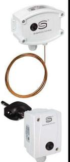
**Frostschutzthermostat stetig ;** für Luft - Heizregister; elektromechanisch; mit aktivem (0...10V) und schaltendem Ausgang; Versorgungsspannung 24V AC/DC; MB: 0...+15°C; Schutzart: IP65; EPU 1x Wechsler (24V); **inkl. Montageklammern**
