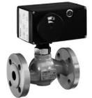
**2-Wege Regelventil;** Flanschanschluss; Ventilgehäuse aus EN-GJS-400-18-LT; **Nenndruck: PN25 druckentlastet** delta pmax. 20 bar; Mediumtemperatur: -10...+150°C; mit Zusatzoption „Dampf- oder Heißwasserausführung“ bis max. +200°C
