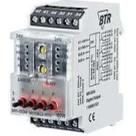
**Modbus RTU I/Os - Feldbusmodul;** AP-Montage durch hohe Schutzart **IP65;** RS 485 Zweidrahtbus; Protokoll: Modbus RTU; Betriebsspannung: 24V AC/DC; mit verschiedenen Ein- und Ausgängen lieferbar; Konfiguration mittels MR-CT Software (diese ist kostenlos zum Downloaden!)
