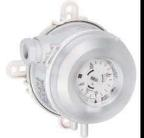
**Differenzdruck- und Volumenstromfühler;** Gehäuse aus schlagfestem Kunststoff; mit unverlierbarem Drehdeckel; 5-Punkt Kalbrierung; **10 Messbereiche einstellbar;** Schutzart: IP65; Möglichkeit zum erfassen des Luft-Volumenstroms (max. 99.999m<sup>3</sup>/h) mittels einstellbarem K-Faktor; inkl. Montage-Set
