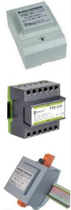
**Steuer- und Trenntransformator;** Einspeisung 400V und 230V mit +/- 15V Klemme ; geeignet für allgemeine Anwendung; Schutzklasse I und Schutzart IP 00; max. Umgebungstemperatur 40°C; Isolationsklasse B; gefertigt gem. EN 61558 2-4, EN 61558 2-6!
