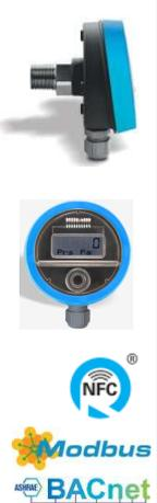
**Druckmessumformer;** aktiv; Relativdruck; Gehäuse und mediumsberührende Teile aus Edelstahl; auch geeignet für Freone (außer NH3); Schutzart IP65; Prozessanschluss G1/2"; Mediumstemperatur: -40...+135°C; Spannung 24V AC/DC (bei 4...20mA 24V DC); mit vorkonfektioniertem 1m Anschlusskabel
